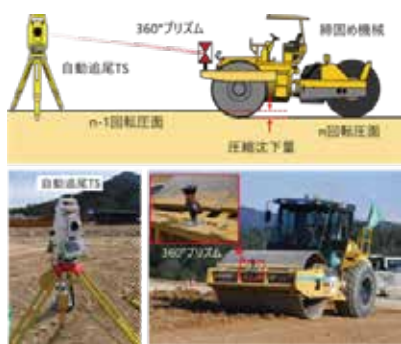
図1 技術①自動追尾型トータルステーションを用いた転圧沈下量計測
