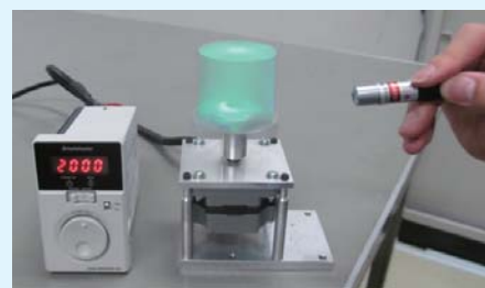
回転スクリーンによる3d表示の可能性 緑色蛍光体を405nmのレーザー光で励起
